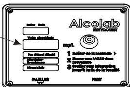
5. Puis l'Alcolab émet un bip sonore et le résultat s'affiche dans le cadre Votre alcoolémie. La limite légale est affichée dans le cadre au-dessus. En cas de présence d'alcool détectée, les indicateurs Faites attention - Ne conduisez pas ou Dépasse la limite s'allument. Si le testeur est sobre, l'indicateur Peu d'alcool détecté s'allume.
