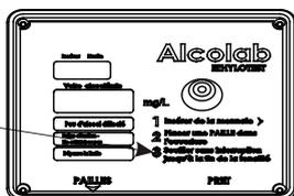
3. Lorsque le message s'allume, insérez la paille dans l'orifice central et attendez que le message **Souffler sans interruption jusqu'à la fin de la tonalité** s'allume. Soufflez de manière modérée et continue dans la paille pendant environ 5 secondes, une tonalité sonore va indiquer le flux correct d'air.
