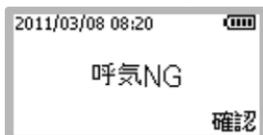
十分な呼気流量もしくは継続的な呼気が確保できませんでした。スタートボタン
