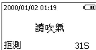
請於倒數計時器的指示時間內完成呼氣測試，倒數結束即返回準備完成。
