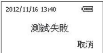
若吹氣中斷或吹氣量不足，分析儀將會迫使中止取樣，並重新開始測試流程。若要取消重新測試，請按下啟動按鈕 ，並選擇取消。
