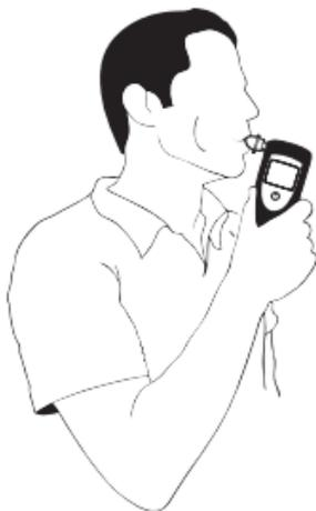
Après la réalisation de plusieurs tests, souffler rapidement dans l'embout pour dégager toute condensation.
