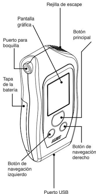
El alcoholímetro evidencial ALERT J5 es fácil de usar. Mide la concentración de alcohol en aliento (BrAC), la cual es directamente proporcional a la concentración de alcohol en sangre (BAC). La lectura se provee en la pantalla.
