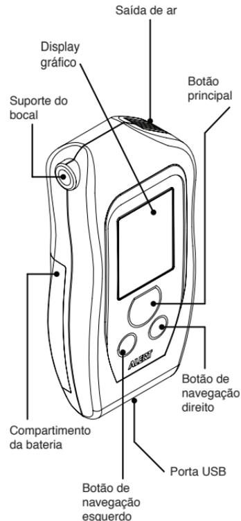
O etilômetro evidencial ALERT J5 é de fácil utilização. Ele mede a concentração de álcool no ar expirado (BRAC) que é diretamente proporcional à concentração de álcool no sangue (BAC). O resultado desta medição é exibido no display.
