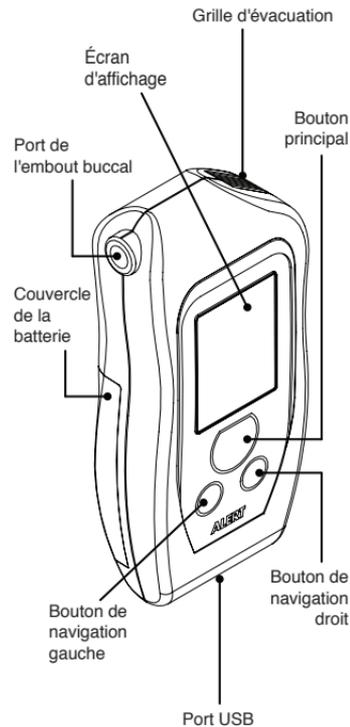
L'éthylomètre de constatation ALERT J5 est facile à utiliser. Il mesure la concentration d'alcool dans l'haleine qui est directement proportionnelle à la concentration d'alcool dans le sang. Le résultat est indiqué sur l'écran.
