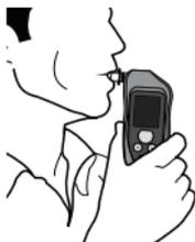
Sopre pelo bocal. Um sinal sonoro contínuo pode ser ouvido, indicando um fluxo adequado de ar. Continue a soprar até que o sinal sonoro seja interrompido. Um sinal sonoro diferente e a mensagem **Teste Cancelado** indicam que a amostra de ar fornecida não foi adequada. Siga as instruções no mostrador para tentar novamente.
