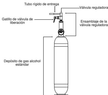
1. Quitar la tapa protectora del depósito y enroscarla en el ensamblaje de la válvula reguladora.
