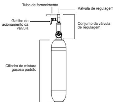
1. Remova a tampa protetora e conecte a válvula reguladora ao cilindro.
