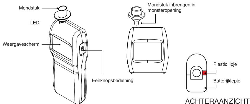
**OPMERKING:** *In de fabriek is een plastic lipje tussen de batterij en het elektrisch contactpunt geplaatst om batterijlading te sparen tijdens transport en opslag. Voor het eerste gebruik van de tester dient dit plastic lipje verwijderd te worden uit het batterijcompartiment, dat toegankelijk is via de achterkant van de tester. U hoeft het klepje niet te openen om het lipje te verwijderen.*
