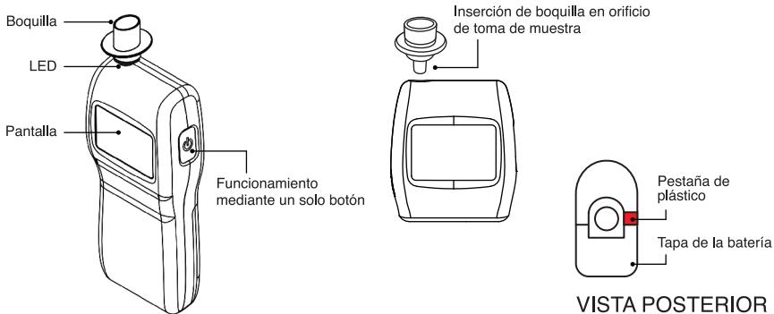
**NOTA:** En la fábrica, se inserta una pestaña de plástico entre la batería y la conexión eléctrica para conservar la carga de la batería durante el envío y el almacenamiento. Para utilizar el probador por primera vez, quite la pestaña de plástico del compartimiento de la batería, en la parte posterior del probador. No necesita abrir la tapa posterior para extraer la pestaña.
