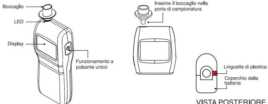
**NOTA:** In fabbrica, è inserire una linguetta di plastica tra la batteria e il collegamento elettrico per conservare la carica della batteria durante la spedizione e la conservazione. Per utilizzare l'etilometro per la prima volta, tirare la linguetta di plastica dal vano della batteria, che è accessibile sul lato posteriore dell'etilometro. Non è necessario aprire il coperchio posteriore per rimuovere la linguetta.
