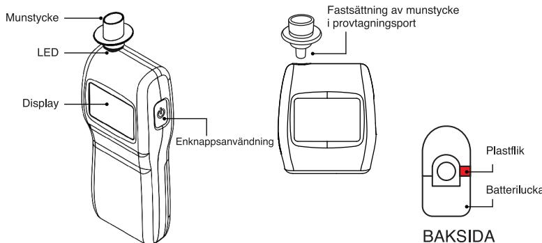
**OBS:** I fabriken placeras plastfliken mellan batteriet och elanslutningen för att bevara batteriets kraft under frakt och förvaring. För att använda denna testare för första gången, dra loss plastfliken från batteriluckan, som sitter på testarens baksida. Du behöver inte öppna luckan för att dra loss fliken.
