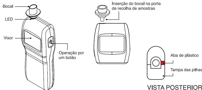
**NOTA:** Na fábrica, é inserida uma aba de plástico entre as pilhas e a ligação elétrica para conservar a carga das pilhas durante o transporte e o armazenamento. Para operar o alcoolímetro pela primeira vez, puxe a aba de plástico do compartimento das pilhas, que pode ser acedida na parte posterior do dispositivo. Não é necessário abrir a tampa posterior para remover a aba.
