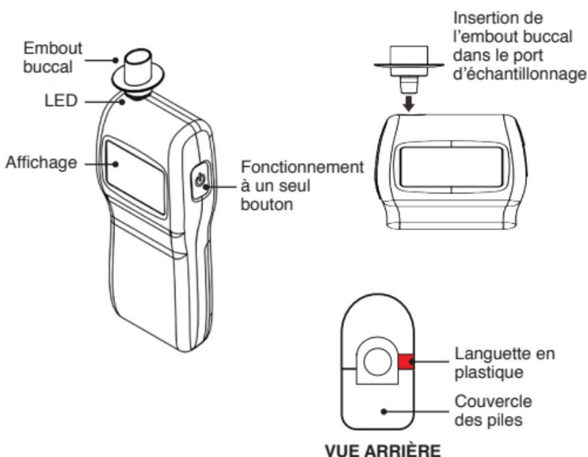
**REMARQUE :** En usine, une languette de plastique est insérée entre la pile et les connexions électriques afin de conserver la puissance de la pile pendant le transport et l'entreposage. Tirer sur la languette de plastique placée sur le compartiment des piles à l'arrière de l'appareil avant de l'utiliser pour la première fois. Vous n'avez pas besoin d'ouvrir le couvercle à l'arrière pour retirer la languette.
