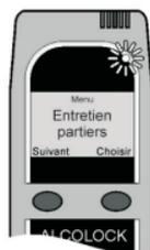
Le menu Entretien par tiers vous permet de désactiver l'EAD en utilisant un code. Il doit être utilisé par les mécaniciens lorsqu'ils inspectent le véhicule.
