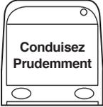
6. Lorsque le DISPOSITIF WR3 détecte que le moteur a démarré, le message **Conduisez prudemment** s'affiche. Le véhicule peut être conduit normalement.
