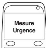
5. Pendant le mode de mesure d'urgence, le véhicule peut être conduit sans faire de test.
