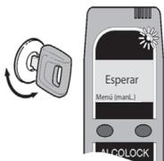
1. Para poner en marcha el aparato, pulse el botón derecho. Durante la fase de puesta en marcha, aparece el mensaje **Esperar**. También se puede poner el dispositivo en marcha girando la llave de encendido para arrancar y apagar el motor.
