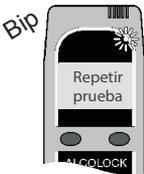
1. El aparato emite un pitido y muestra en pantalla **Repetir prueba**.
