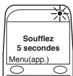
2. L'analyseur est prêt quand le message «**Soufflez 5 secondes**» s'affiche. Le temps de préchauffage est plus long en cas de basses températures.
