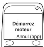
3. L'analyseur émet un «**bip**» et affiche Démarez moteur. Il sera nécessaire d'effectuer un test au prochain démarrage du véhicule.
