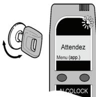
1. Appuyez sur le bouton **droit** ou mettez la clé de contact en position «**off**» pour activer l'analyseur.
