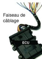
1. Préparez le faisceau de l'ECU en dénudant les fils sur environ 1 à 2 centimètres, et insérez des gaines thermo rétractables sur tous les fils, excepté sur les fils noirs, rouges et blancs.
