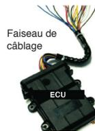
Le faisceau de l'ECU est constitué de 14 fils de couleur. Seuls 8 d'entre eux doivent être reliés à des points spécifiques du câblage du système électrique du véhicule (voir tableau). Les 6 autres fils sont utilisés pour brancher des accessoires optionnels. Les connexions sont faites par épissure dans les recommandations ci-dessous. Toutefois, si ceci diffère des instructions des constructeurs ou des directives européennes, ces dernières doivent être suivies.
