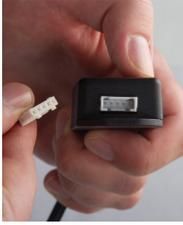
5. Localiser le connecteur blanc à 5 broches du câble de l'ECU et le recouvrir d'un tube thermorétractable (79-000262). Ne pas sceller le tube thermorétractable à moins d'instruction contraire.
