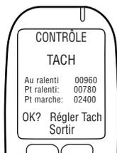
**REMARQUE:** Après avoir appuyé sur **Régler Tach**, la vitesse de rotation **Au ralenti** (tr/min) (affichée sur la 1e ligne) est utilisée pour régler automatiquement les seuils de vitesse (tr/min) des **Pt ralenti** et **Pt marche** (des 2e et 3e lignes).
