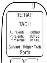
3. Si les seuils de vitesse (tr/min) sont corrects, appuyer sur **Suivant** (sinon appuyer sur **Régler Tach** jusqu'à l'obtention d'un seuil de vitesse (tr/min) correct).
