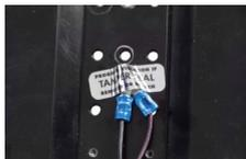
3. Plomber les tubes thermorétractables au dessus des câbles reliés et soudés ensemble (s'il y a lieu).
