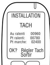
2. Si la vitesse de rotation **Au ralenti** (tr/min) affichée est acceptable, appuyer sur **Régler Tach** pour régler les seuils de vitesse (tr/min).
