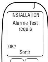
**Alarme Test requis** s'affiche (même si non utilisée). Le voyant LED du combiné est éteint. L'alarme pour tests de confirmation (si utilisée) clignote. Après que l'alarme ait clignoté 3 fois, **OK** s'affiche. (Si aucune alarme pour tests de confirmation n'est utilisée, attendre qu'**OK** s'affiche).
