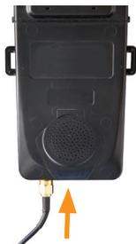
1. Attacher la fiche du câble du GPS au port de communication au bas de l'ECU.
