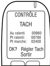
**REMARQUE:** Après avoir appuyé sur "Régler Tach", la vitesse de rotation (tr/min) "Au ralenti" (sur la 1<sup>e</sup> ligne) est utilisée pour régler les seuils de vitesse (tr/min) des "Pt ralenti" et "Pt marche" (des 2<sup>e</sup> et 3<sup>e</sup> lignes).
