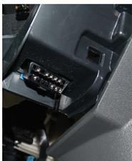
4. Monter le connecteur de l'ensemble câble de l'OBD-II (port femelle) à la place du connecteur femelle détaché au point 2.
