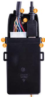
1. Tenir l'ECU avec le connecteur tourné vers le haut (comme sur le croquis) et attacher la clip avant (58-000527) en emboîtant la partie à rainures de la clip sur la partie crantée de l'ECU ① ②.
