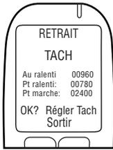
2. Si la vitesse de rotation **Au ralenti** (tr/min) affichée est acceptable, appuyer sur **Régler Tach** pour régler les seuils de vitesse (tr/min).
