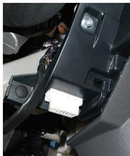
1. Localiser le connecteur OBD-II du véhicule (port femelle) qui est attaché à la carrosserie du véhicule – habituellement à moins de 60 cm du volant.
