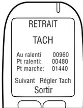
3. Si les seuils de vitesse (tr/min) sont corrects, appuyer sur **Suivant** (sinon appuyer sur **Régler Tach** jusqu'à l'obtention d'un seuil de vitesse (tr/min) correct).
