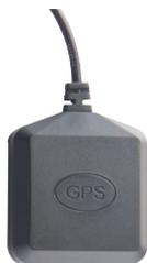
3. Placer l'antenne du GPS à l'intérieur du véhicule à un endroit en ligne directe avec le ciel, de préférence sur le tableau de bord.
