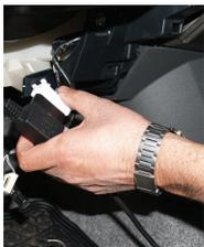
2. Détacher le connecteur OBD-II de la carrosserie du véhicule, tout en maintenant la connexion des fils.
