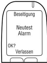
**Neutest Alarm** wird angezeigt (auch, wenn nicht verwendet). Das MG-LED-Licht ist aus (wenn verwendet) blinkt der Neutestalarm. Nachdem der Neutest Alarm 3 Mal blinkt, wird **OK?** angezeigt (wenn kein Neutestalarm verwendet wird, warten Sie bis **OK?** angezeigt wird).
