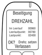
1. Überprüfen Sie, dass der Rpm-Messwert **Im Leerlauf** die Rpm-Anzeige am Armaturenbrett widerspiegelt.
