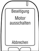
Wenn der **Lastpunkt** wert zulässig ist, wird automatisch **Motor ausschalten** angezeigt, sobald die Motor-Rpm den Wert in der dritten Zeile übersteigt.
