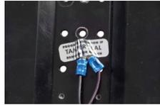
3. Versiegeln Sie die Wärmeschrumpfschläuche über den gelöteten Kabelverbindungen (wo zutreffend).
