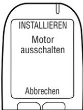
Wenn der **Lastpunkt** Wert zulässig ist, wird automatisch **Motor ausschalten** angezeigt, sobald die Motor-Rpm den Wert in der dritten Zeile übersteigt.
