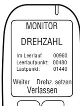
3. Wenn die Drehzahlmessergrenzbereiche zulässig sind, drücken Sie auf **Weiter** (ansonsten drücken Sie Drehzahlmesser einstellen, bis ein zulässiger Drehzahlmessergrenzbereich erhalten wird).
