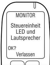
**Steuereinheit LED und Lautsprecher** wird angezeigt. Das MG-LED-Licht ist aus. Das ESG piepst und die Tonhöhe steigt bei drei Piepstönen ab. Nach dieser Sequenz wird **OK?** angezeigt.
