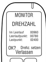
**HINWEIS:** Nachdem **Drehz. setzen** gedrckt wurde, wird der Rpm-Messwert Im Leerlauf (in der ersten Zeile) dazu verwendet, die Drehzahlmessergrenzbereiche des Leerlaufpunkts und des Lastpunkts (die zweite und dritte Zeile) zurckzusetzen.
