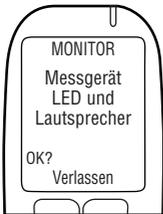
**Messgerät LED und Lautsprecher** wird angezeigt. Das MG-LED-Licht leuchtet zuerst rot dann **grün** dann **gelb** auf. Bei jedem Aufleuchten piepst das MG in absteigender Tonhöhe. Nach dieser Sequenz erscheint **OK?**.
