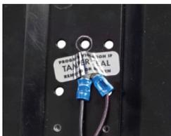
2. Verbinden Sie ESG-Draht 19 (Braun) mit ESG-Draht 12 (Rot).
