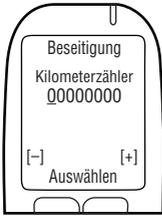
Nachdem der Grenzbereich für den Drehzahlmesser oder die Geschwindigkeit eingestellt wurde, wird **Kilometerzähler** angezeigt.
