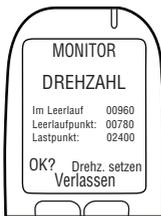
2. Wenn der Rpm-Messwert **Im Leerlauf** zulässig ist, drücken Sie **Drehz. setzen**, um die Rpm-Grenzbereiche zurückzusetzen.
