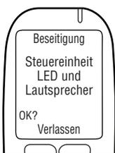
**Steuereinheit LED und Lautsprecher** wird angezeigt. Das MG-LED-Licht ist aus. Das ESG piepst und die Tonhöhe steigt bei drei Piepstönen ab. Nach dieser Sequenz wird **OK?** angezeigt.
