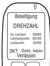
2. Wenn der Rpm-Messwert **Im Leerlauf** zulässig ist, drücken Sie **Drehz. setzen**, um die Rpm-Grenzbereiche zurückzusetzen.
