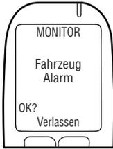
**Fahrzeug Alarm** wird angezeigt. Das MG-LED-Licht ist aus. Die Alarm hupe ertönt und (wenn verwendet) die Alarmblinkeinrichtung blinkt. Nachdem die Alarmhupe dreimal ertönt und die Alarmblinkeinrichtung dreimal blinkt (wenn verwendet) wird **OK?** angezeigt.
