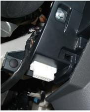
1. Orten Sie den Fahrzeug-OBD-II-Anschluss, der an den Fahrzeugsicherungskasten gekoppelt ist – normalerweise befindet sich dieser im Umkreis von 2 Fuß des Lenkrads.
