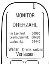
3. Wenn die Drehzahlmessergrenzbereiche zulässig sind, drücken Sie auf **Weiter** (ansonsten drücken Sie Drehzahlmesser einstellen, bis ein zulässiger Drehzahlmessergrenzbereich erhalten wird).
