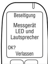
**Messgerät LED und Lautsprecher** wird angezeigt. Das MG-LED-Licht leuchtet zuerst **rot**, dann **grün**, dann **gelb** auf. Bei jedem Aufleuchten piepst das MG in abfallender Ton höhe. Nach dieser Sequenz erscheint **OK?**.
