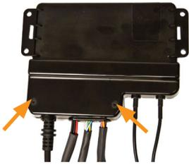
5. Stecken Sie die Schraube (45-000143) in das Schraubenloch am Clip für die Rückseite, um die Clips zu befestigen.
