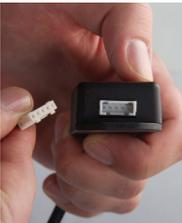
5. Orten Sie den weißen, fünfpoligen Verbinder vom ESG-Kabel und bringen Sie den schwarzen Warmschrumpfschlauch (79-000262) darüber an. Versiegeln Sie den Warmschrumpfschlauch erst, wenn Sie dazu angeleitet werden.
