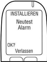
**Neutest Alarm** wird angezeigt (selbst wenn nicht verwendet). Das MG-LED-Licht ist aus. (Wenn verwendet) blinkt der Neutestalarm. Nachdem der Neutestalarm 3 Mal blinkt, wird **OK?** angezeigt (Wenn kein Neutestalarm verwendet wird, warten Sie, bis **OK?** angezeigt wird).
