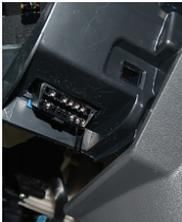
4. Montieren Sie den weiblichen Steckverbinder des OBD-II-Kabelbausatzes an Stelle des Verbinders, den Sie in Schritt zwei abgekoppelt haben.
