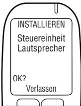
**Steuereinheit Lautsprecher** wird angezeigt. Das MG-LED-Licht ist aus. Das ESG piepst und die Tonhöhe fällt drei Piepstöne ab. Nach dieser Sequenz wird **OK?** angezeigt.
