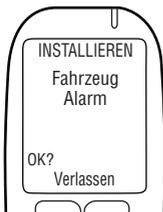
**Fahrzeug Alarm** wird angezeigt. Das MG-LED-Licht ist aus. Die Alarmhupe ertönt und (wenn verwendet) die Alarmblinkeinrichtung blinkt. Nachdem die Alarmhupe dreimal ertönt und die Alarmblinkeinrichtung dreimal blinkt (wenn verwendet) wird **OK?** angezeigt.
