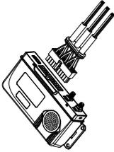
1. Verbinden Sie das ESG-Kabel (13-001151) mit dem ESG-Hauptanschluss. Das Kabel schnappt ein und das ESG piepst.
