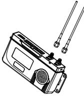
7. Verbinden Sie die Antenne (04-000009) mittels der SMA-Stecker am Ende der Kabel mit den GPS- und GPRS-Schnittstellen des LR max Relaismoduls. Die GPS- und GPRS-Schnittstellen sind auf der Vorderseite des Gehäuses deutlich gekennzeichnet.
