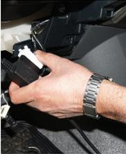
2. Koppeln Sie den Fahrzeug-OBD-II-Anschluss vom Fahrzeugsicherungskasten ab, wobei die Kabel verbunden bleiben sollten.
