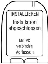
Nachdem der Kilometerzählerwert akzeptiert wurde, wird **Installieren abgeschlossen, Mit PC verbinden** angezeigt.
