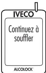
Soufflez modérément et de façon continue. Le récepteur émettra une tonalité indiquant que le débit d'air sont acceptés et affichera « **Continuez à souffler** ». Si vous ne soufflez pas correctement, un message apparaîtra sur l'écran indiquant les mesures correctives à faire. NE tentez PAS un autre test jusqu'à ce que l'afficheur indique « **Soufflez 5 secondes** ».
