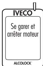
Cet écran apparaîtra si un test de confirmation a été échoué pendant que le moteur tournait. Le voyant clignote en rouge et une tonalité retentit. Vous avez échoué au test. Le taux d'alcoolémie détecté est supérieur à la limite prédéfinie. Stationnez à un endroit sûr et coupez le moteur du véhicule.
