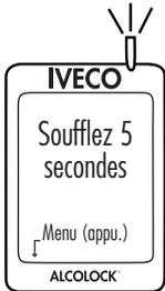
Le voyant clignote en vert et le récepteur affiche « **Soufflez 5 secondes** » quand il atteint sa température optimale. Le temps de préchauffage peut être plus long à des températures froides.
