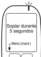
La luz del indicador titilará en verde y el mando remoto mostrará **Soplar durante 5 segundos** cuando haya alcanzado la temperatura óptima. El tiempo de calentamiento puede ser más largo en temperaturas frías.
