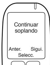
Sople de manera moderada y continua. El mando remoto emitirá un tono que indica que el flujo de aire adecuado y mostrará **Continuar soplando**. Si no está soplando correctamente, aparecerá un mensaje en la pantalla que indicará la acción correctiva necesaria. NO intente realizar otra prueba de aliento antes de que la pantalla muestre el **Soplar durante 5 segundos**.
