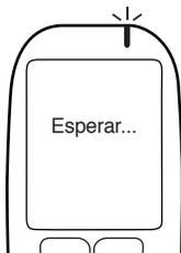
Encienda el dispositivo presionando cualquier botón de navegación. Aparecerá el mensaje **Esperar...** en la pantalla hasta que el mando remoto se caliente. La luz del indicador titilará en ámbar.
