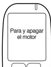
Esta pantalla aparece si una repetición de la prueba resulta fallida cuando el motor está encendido. La luz del indicador titila en rojo y se oye un tono. No ha superado la prueba de aliento. El nivel de alcohol detectado supera el límite preestablecido. Estacionese en un lugar seguro y apague el motor del vehículo.
