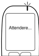
Accendere il dispositivo premendo un qualsiasi pulsante di navigazione. Il testo **Attendere...** sarà visualizzato sul display fino a quando il dispositivo non si sarà riscaldato. L'indicatore luminoso lampeggia in color ambra.
