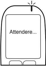
Quando un test del respiro è stato accettato, si sentirà un click, continuare a soffiare fino a quando il suono non smette. Il display indicherà **Attendere...** mentre viene analizzato il campione di respiro.
