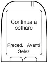
Soffiare moderatamente e continuamente. Il dispositivo emetterà un suono per indicare che ha accettato il flusso d'aria, e mostrerà **Continua a soffiare**. Se non si sta soffiando correttamente, verrà visualizzato un messaggio sul display che indica le misure correttive necessarie. **NON** tentare di effettuare un altro test del respiro fino a quando il display non indicherà **Soffiare per 5 secondi**.
