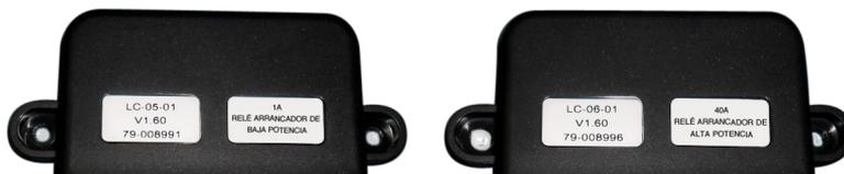
El kit estándar contiene un Relé de Alta Potencia de 40A. Utilice el Relé de Baja Potencia cuando el interruptor de ignición para el relé de arranque sea inferior a 1A. El Relé de Arranque de Baja Potencia incluye un fusible restaurable en línea interno que se abrirá cuando se exceda la capacidad de corriente 1A.
