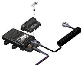
**NOTA:** Posicione la ECU de manera tal que no interfiera con la operación normal del vehículo.
