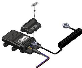
**15.** Isole as conexões do chicote elétrico com fita isolante ou tubos termoretráteis e amarre os fios com a braçadeira plástica. Conecte tanto o chicote elétrico como o cabo da unidade manual na ECU. Alinhe o invólucro de segurança com o encaixe na ECU e com os anéis de borracha de ambos os cabos e aperte as duas metades para fechá-lo. Insira e aperte o parafuso. Se utilizado, encaixe o plug do parafuso e coloque o lacre colante. Recoloque o painel do veículo.
