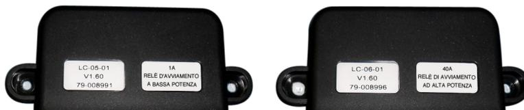
Il kit standard contiene il relè 40A ad alta potenza. Utilizzare il Relè a Bassa Potenza quando l'interruttore di accensione del relè di avviamento è inferiore a 1A. Il Relè a Bassa Potenza include un fusibile ripristinabile in linea interna che si aprirà ogni volta che il valore attuale di 1A verrà superato.
