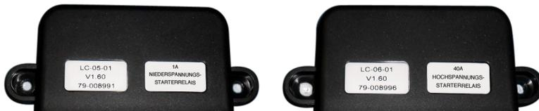
Das Standard-Kit enthält das 40A Hochspannungsrelais. Verwenden Sie das Niederspannungsrelais wenn der Zündschalter und das Starterrelais weniger als 1A haben. Das Niederspannungs-Startrelais umfasst eine interne inline zurücksetzbare Sicherung, die stets unterbricht, wenn die Strombelastung 1A überschreitet.
