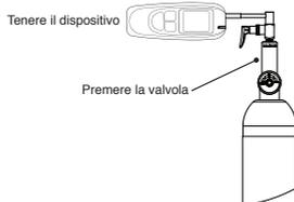
Viene visualizzato un messaggio **Blowing** (Soffiare) e il dispositivo emette un segnale.
