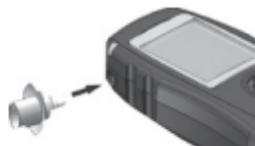
Soufflez pendant 4 secondes s'affichera lorsque le Récepteur est prêt pour un test d'alcoolémie.
