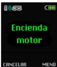
**1. Encienda motor** - Ha superado la prueba de aliento y no se ha detectado alcohol. Puede encender el motor del vehículo.
