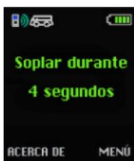
La pantalla indicará **Soplar durante 4 segundos** y la luz indicadora se iluminará en verde cuando el Receptor está listo para una prueba de aliento. El tiempo de calentamiento puede ser más largo en temperaturas frías.
