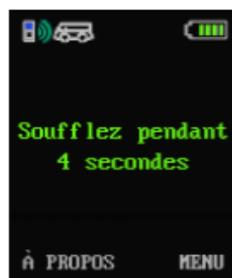
L'écran affichera **Blow for 4 seconds (Soufflez pendant quatre secondes)** et le voyant lumineux deviendra vert lorsque l'analyseur sera prêt pour un test respiratoire. Le temps de réchauffement pourrait être plus long pour des températures froides.
