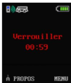
**3. Verrouiller** - Le niveau d'alcool détecté est supérieure à la limite préétablie. Vous ne pouvez PAS démarrer le moteur du véhicule.
