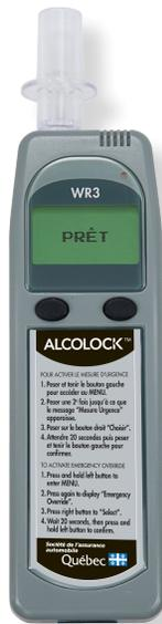
Cependant, lorsque le démarrage est autorisé suite à un essai réussi, des tests subséquents sont requis à des intervalles aléatoires (au hasard) tant que le moteur est en marche.
