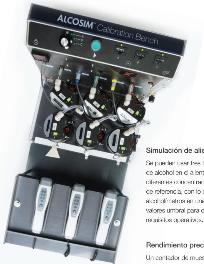
El Banco de Calibración ALCOSIM (ALCOSIM Calibration Bench) es una estación de calibración multietapas que optimiza el flujo de gas y el uso de la solución de referencia de alcohol, lo que elimina el error humano y proporciona muestras de aliento simuladas consistentes para la calibración de los probadores de alcohol en el aliento.
