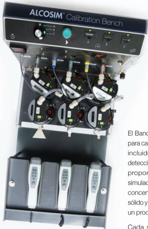
El Banco de Calibración ALCOSIM se utiliza para calibrar todos los tipos de alcoholímetros, incluidos los instrumentos pasivos y de detección. El Banco de Calibración ALCOSIM proporciona una configuración de seis simuladores para tres puntos de ajuste de concentración separados, tiene un cuerpo sólido y una plataforma ajustable, y proporciona un proceso de calibración rápido y confiable.
